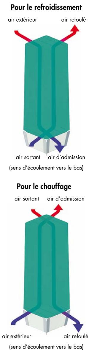
Figure 8 : orientation de montage « sur les panneaux latéraux (blancs) »
