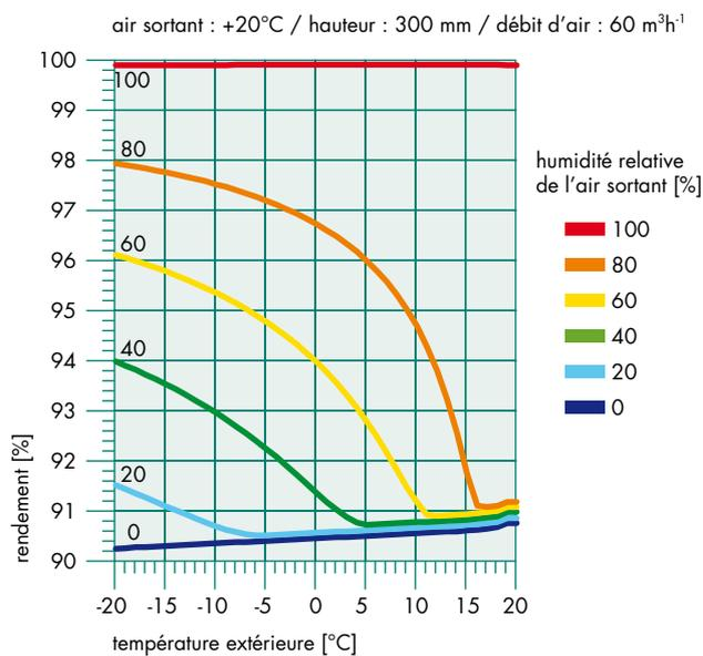
Figure 6 : Température de l'air refoulé en fonction de la température extérieure.
