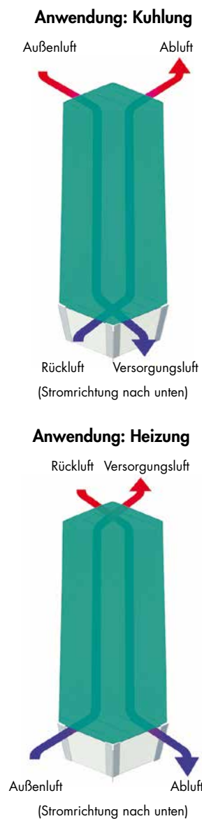
Abbildung 7: Montageausrichtung "auf den Nasen"
